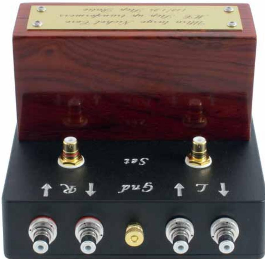
Sul pianale davanti al contenitore dei trasformatori in legno di cocobolo vi sono i due connettori dorati destinati ad ospitare le reti armonizzatrici contenute all'interno di spinotti RCA maschi; sul frontalino trovano invece posto i quattro connettori rodiali di ingresso e di uscita.
